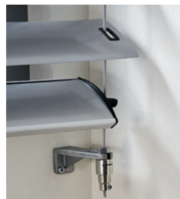
Lamellenbreite 80 mm, flexibel, mit Winkel und Federtopf zur automatischen Seilspannung
